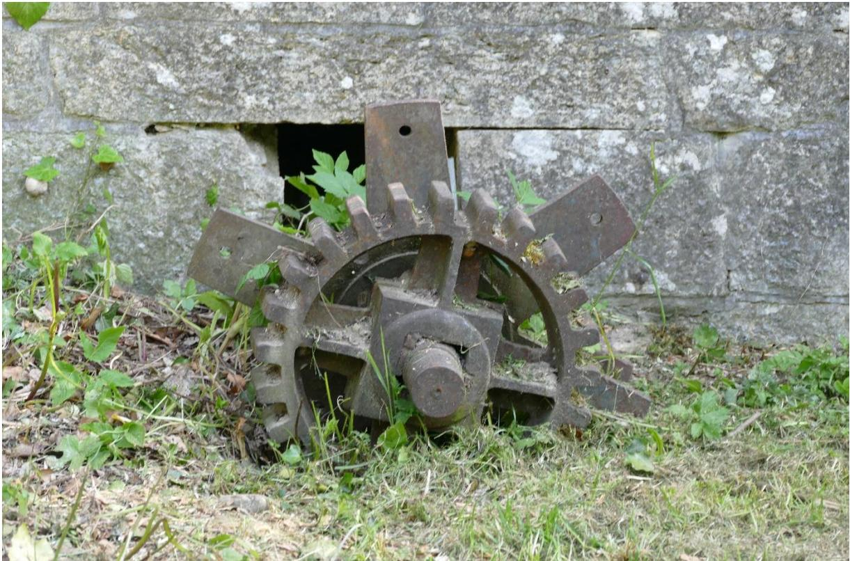
Un vestige extérieur se trouve sous forme d'une roue dentée dans le Pré du Château. L'axe de cette roue communique, sous l'arche, avec ce qui a été considéré à tort comme une roue à eau, mais qui n'a pas de contact avec le niveau du Nozon ni la possibilité d'être abaissée dans l'eau. Il s'agirait alors d'une poulie destinée à transmettre l'énergie par un jeu de courroies au rez de chaussée de l'annexe sud MdP.
